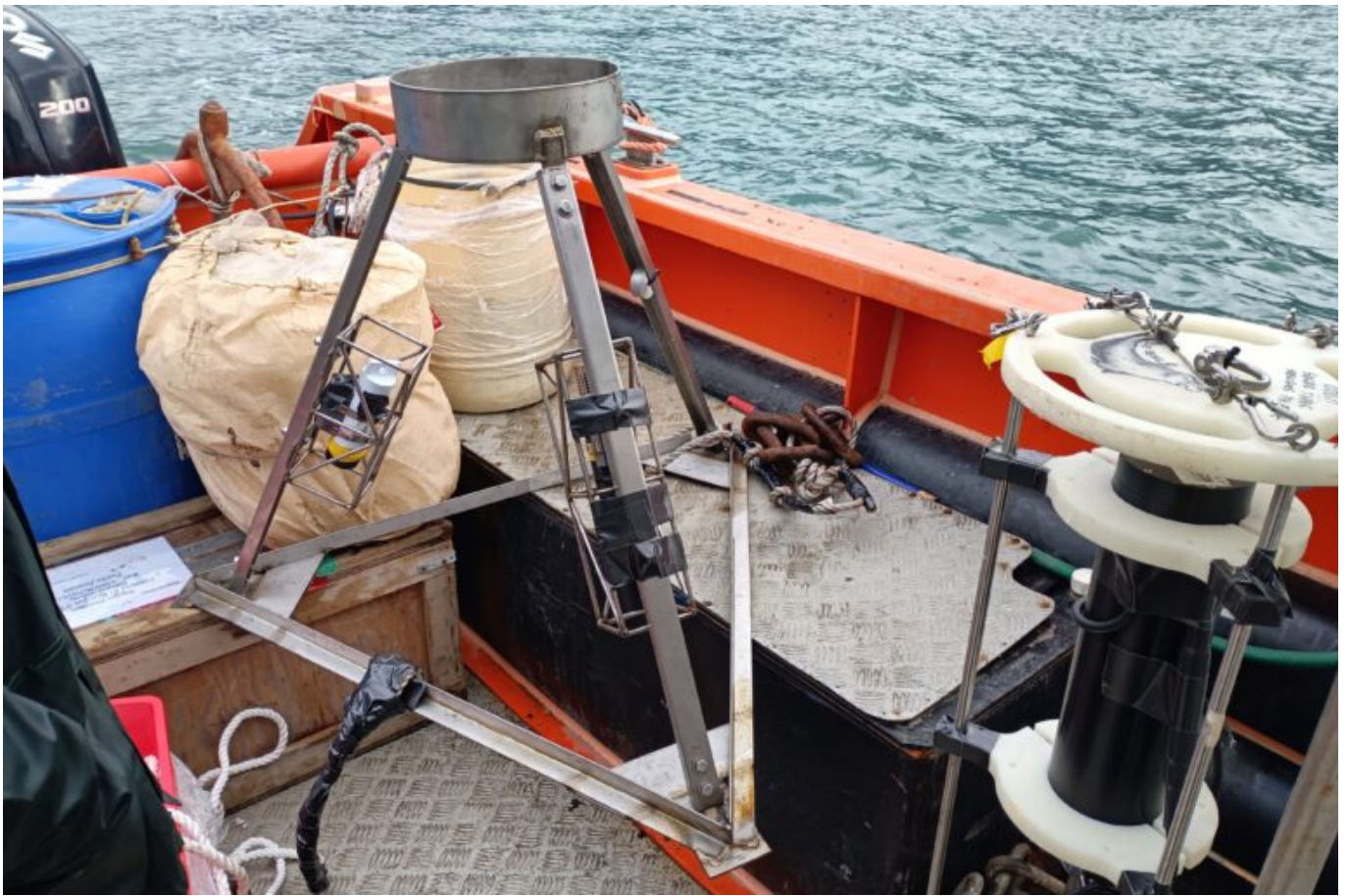
Estructura de acero inoxidable utilizada para posicionar instrumentos que estudian las condiciones del fondo marino. Foto: cortesía Manuel Castillo
