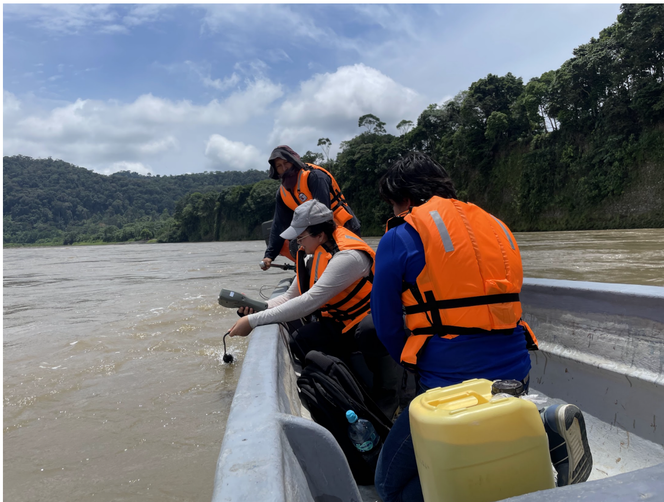
El equipo de la Fundación Ecociencia usó una sonda multiparámétrica para analizar el agua del río Santiago en busca de metales pesados introducidos por la minería ilegal. Foto: Ana Cristina Alvarado
