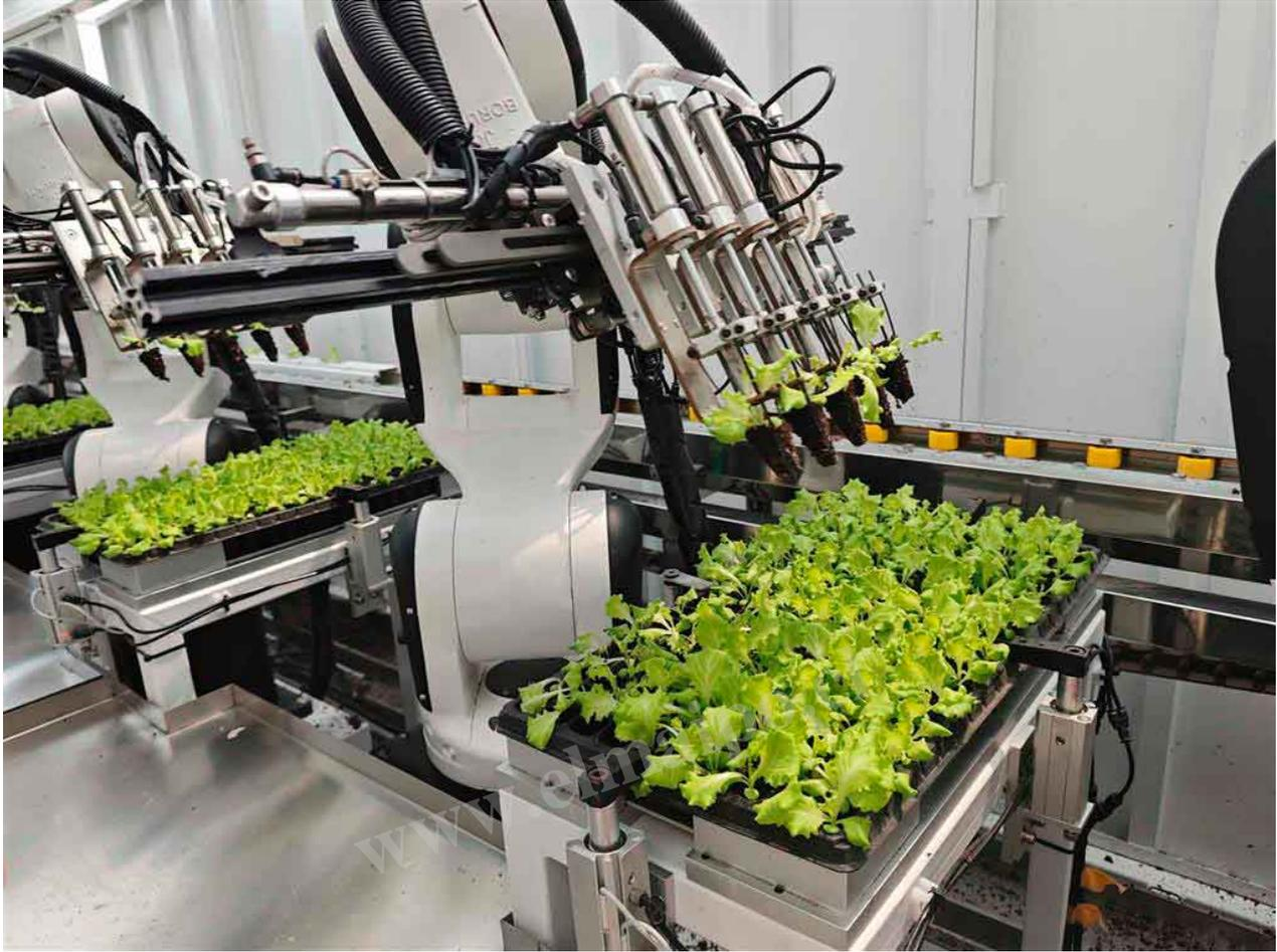
El proceso productivo comprende seis etapas: paletización automática, colocación de cestas de plantación, trasplante preciso, rotación de tuberías, plantación y cosecha, excepto esta última, todas las fases son completamente automatizadas.
