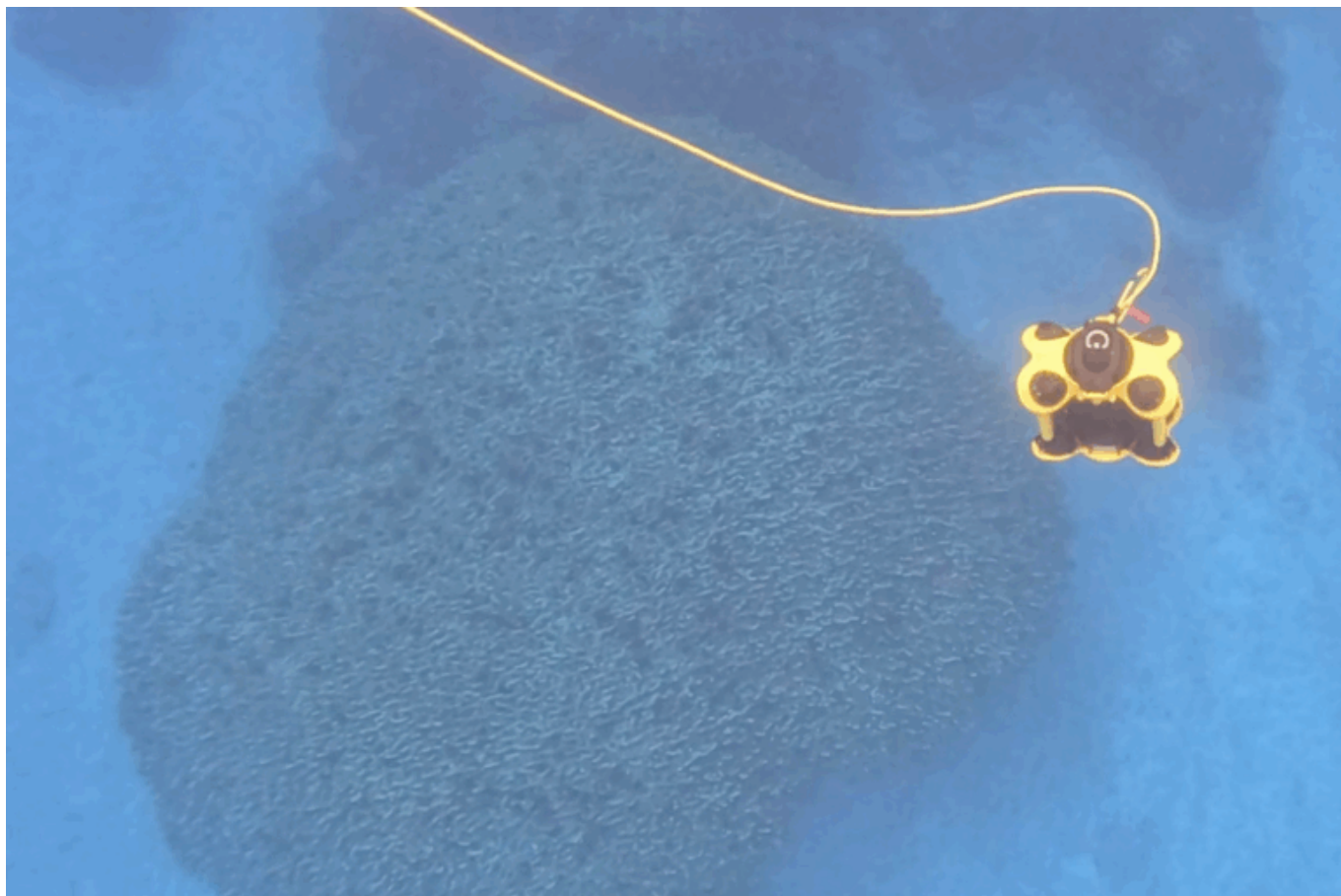
Cámara submarina utilizada para el monitoreo de erizos negros en Rapa Nui. Foto: cortesía CIMARQ
